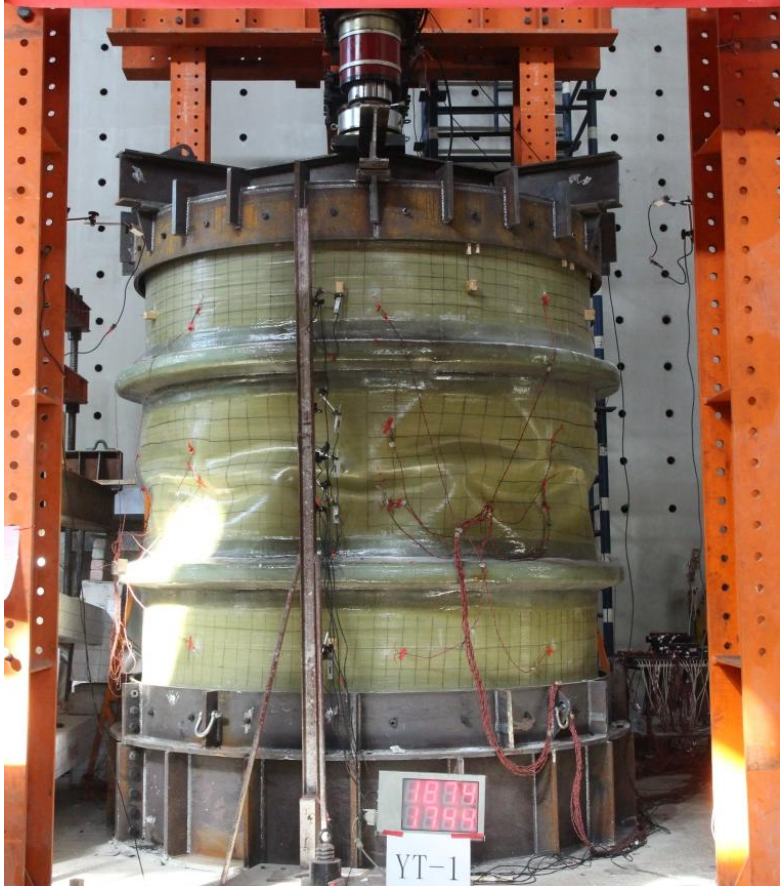
大型玻璃钢排烟筒缩比模型试验
