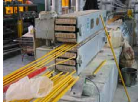
图 7 GFRP 拉挤生产：成型
