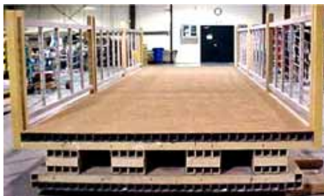
图 17 用统一拉挤型材制成的全 FRP 桥
