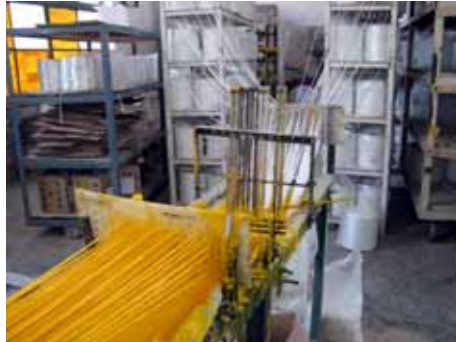
图 6 GFRP 拉挤生产：喂料、浸胶
