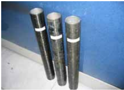
图 1 CFRP—铝合金组合管 Fig.1 CFRP—aluminum alloy composite pipe
